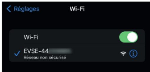
Lorsque l'appareil est connecté au réseau la borne de rechargement est accessible via un navigateur smartphone ou ordinateur en saisissant l'adresse IP suivante **192.168.4.1** dans la barre de l'url, pour arriver sur l'écran de connexion.
