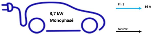
Comment fonctionne la recharger électrique pour un véhicule de 3,7 kW ?
