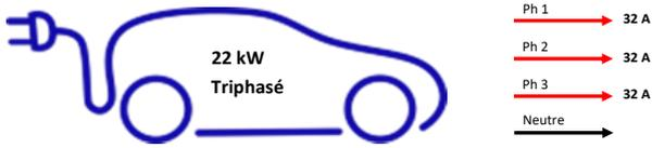
Comment fonctionne la recharger électrique pour un véhicule de 22 kW ?
